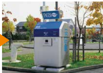
攪拌しながら微生物で一次処理
